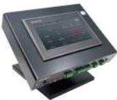
DaqBox為核心系統主機，只需連接PLC接點或是生產設備上的感應器訊號，便可自動搜集設備運作與生產狀態，並轉換為有效的資訊。DaqBox採觸控式、圖形化直覺操作，還可獨立將資訊傳送至大型LED字幕（DaqLED）或電視螢幕（DaqMedia）做現場目視化管理。
